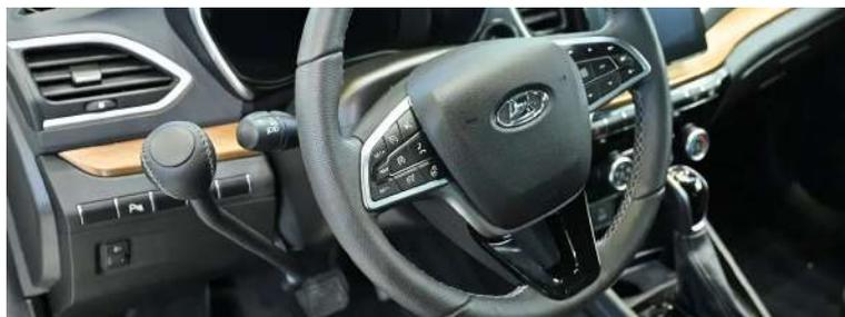
**В рамках ПМЭФ-2024 на стенде Самарской области LADA впервые представила предсерийную модификацию LADA Vesta с ручным управлением. Система позволяет комфортно и безопасно водить автомобиль людям с нарушением функций одной или обеих ног.**
